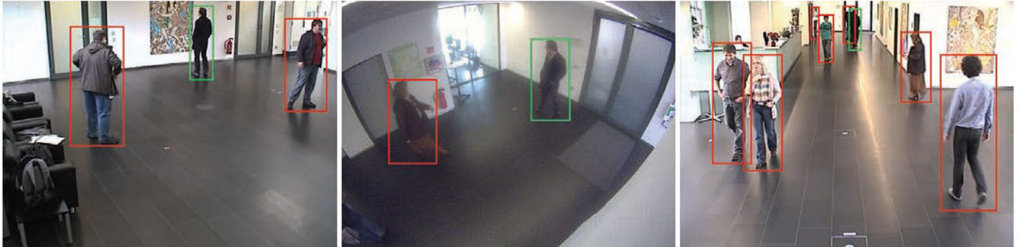
Abb. 1: Die Wiedererkennung einer Person (grün) in typischen Bilddaten eines Kameranetzwerkes wird erschwert durch variierende Kamerablickwinkel, Beleuchtungseffekte, Bildauflösung und -qualität, Verdeckungen und Variationen in der Pose von Personen (Bildquelle [1]).
