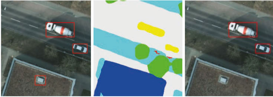
Abb. 2: Die Anzahl an Falschalarmen aufgrund fahrzeugähnlicher Strukturen (links) lassen sich durch Einbeziehung der semantischen Segmentierung einer Szene (mitte) reduzieren (rechts). Bildquelle: Ausschnitt aus ISPRS-Datensatz http://www2.isprs.org/tl_files/isprs/wg34/docs/ComplexScenes_revision_v4.pdf + eigene Ergebnisse.
