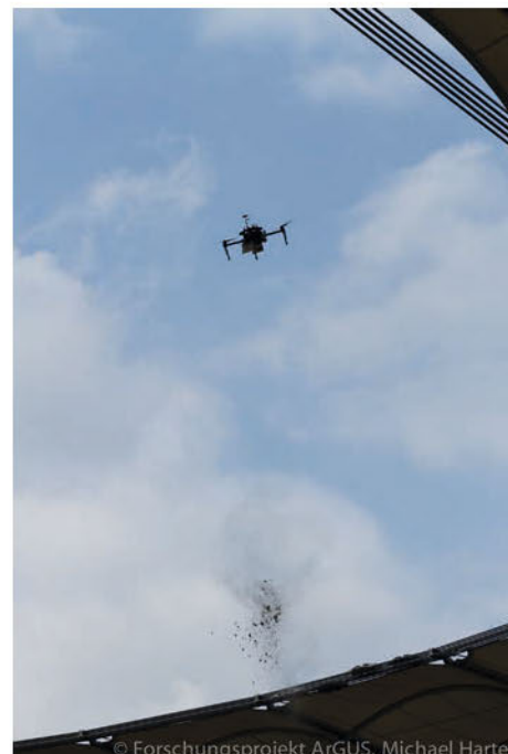
Eine Drohne wirft im Volksparkstadion Hamburg Pulver ab. In diesem Fall handelt es sich nur um ein paar Gramm Mehl.
