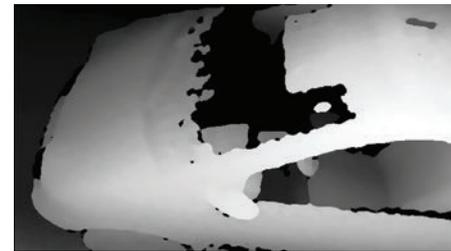
Im Multi-3D-Kamerasystem bilden Entfernungskarten die Grundlage für die Berechnung der Raumkoordinaten der Oberflächenmesspunkte.
