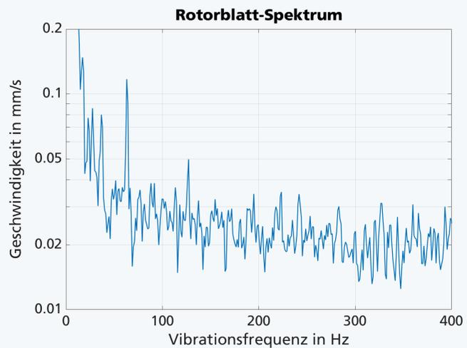
Vibrationsspektrum eines WEA-Rotorblatts.
