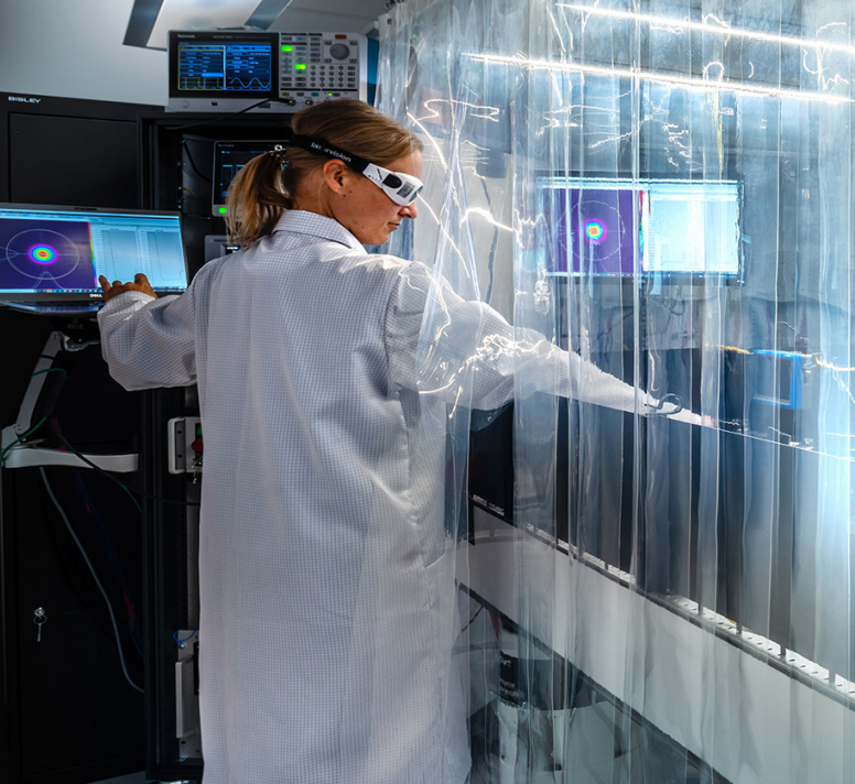
Mitarbeiterin bei der Charakterisierung eines Hochleistungs-Festkörperlasers.
