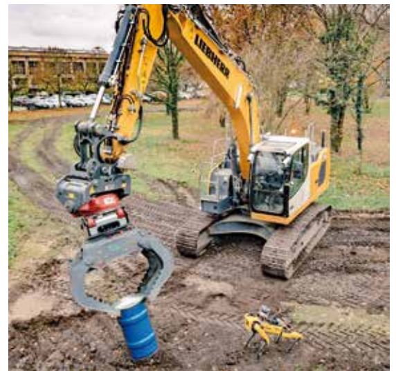
Ein Team autonom agierender Roboter (Robo-Hund und Bagger) in Aktion: Ein Eindruck von aktuellen Tests am Fraunhofer IOSB
