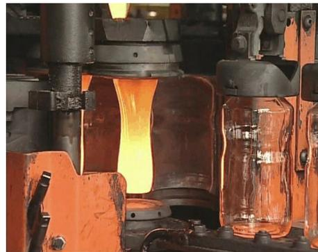
*Abbildung 1: Pressform zur Herstellung von Behälterglas*
