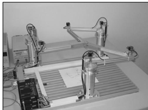
Abbildung 1: Parallelroboter
