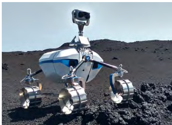
Abbildung 1: DLR Lightweight Rover Unit (LRU) in der ROBEX Mond-Analog Mission auf dem Ätna [dlr.de]
