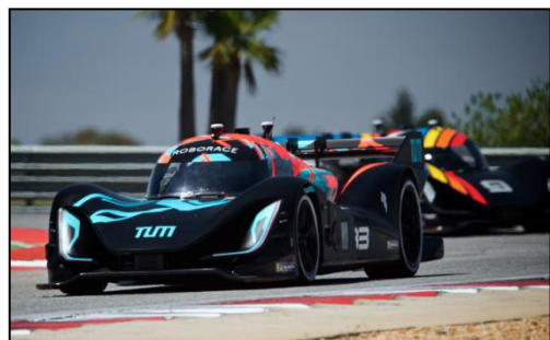
Abbildung 2: Autonomes Elektrorennfahrzeug „DevBot 2.0“ auf der Rennstrecke Montebianco, Spanien
