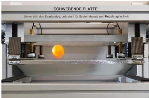
Abb. 2 Magnetisch gelagerte Platte mit Tischtennisball (Foto: Oliver Dietze)
